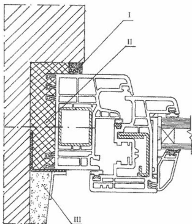
I – наружный водоизоляционный паропроницаемый слой;
