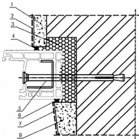
1 – отделка наружного откоса штукатурным раствором с коэффициентом паропроницаемости в соответствии с требованиями настоящего стандарта; 2 – паропроницаемая фасадная окраска; 3 – пенный утеплитель; 4 – герметик; 5 – рамный дюбель; 6 – герметик; 7 – окрасочная пароизоляция; 8 – слой штукатурного раствора с высоким коэффициентом сопротивления паропроницанию
