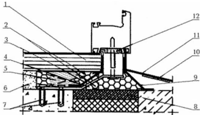
1 – подоконная доска; 2 – пенный утеплитель; 3 – пароизоляционная лента; 4 – гибкая анкерная пластина; 5 – опорная колодка под подоконную доску; 6 – штукатурный раствор; 7 – дюbelь со стопорным шурупом; 8 – вкладыш из антисептированного пиломатериала; 9 – водоизоляционная паропроницаемая лента; 10 – шумопоглощающая прокладка; 11 – слив; 12 – изоляционная саморасширяющаяся паропроницаемая лента
