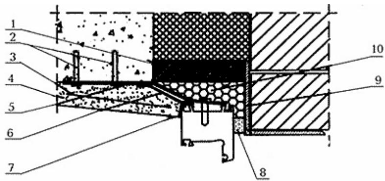
1 – вкладыш из атисептированного пиломатериала; 2 – дюбель со стопорным шурупом; 3 – армирующая сетка; 4 – штукатурный слой внутреннего откоса (с фаской для слоя герметика), возможна отделка листовым материалом (влагостойкая панель); 5 – гибкая анкерная пластина; 6 – пароизоляционная лента; 7 – герметик; 8 – изоляционная саморасширяющаяся паропроницаемая лента; 9 – стальная перемычка с антикоррозионным покрытием; 10 – пенный утеплитель;
