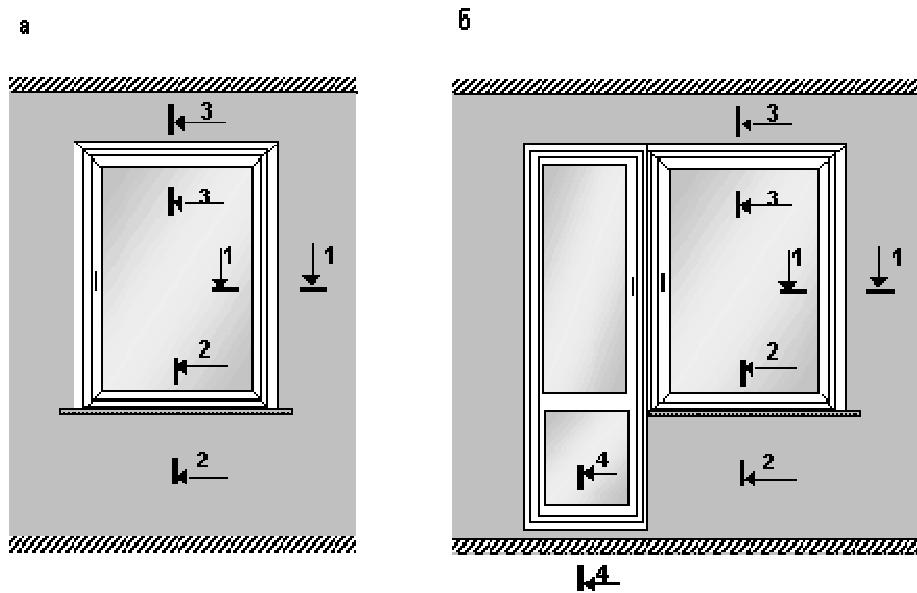
*Рисунок Г.2 Расчетная схема (а) и схема задания граничных условий (б) узла примыкания оконного блока к оконному проему:*
