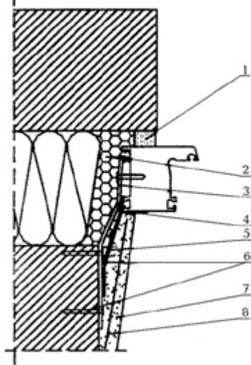
1 – изоляционная саморасширяющаяся паропроницаемая лента; 2 – пенный утеплитель; 3 – гибкая анкерная пластина; 4 – герметик; 5 – пароизоляционная лента; 6 – дюbelь со стопорным шурупом; 7 – штукатурный слой внутреннего откоса (с фаской для слоя герметика); 8 – армирующая сетка
