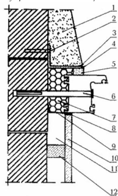
1 – штукатурный слой наружного откоса (с фаской для слоя герметика); 2 – строительный шуруп; 3 – герметик; 4 – фальшчетверть из уголка; 5 – изоляционная саморасширяющаяся паропроницаемая лента; 6 – рамный дюбель; 7 – пенный утеплитель; 8 – герметик; 9 – пароизоляционная лента; 10 – элемент отделки внутреннего откоса; 11\* – здесь и далее полость может быть заполнена теплоизоляционным
