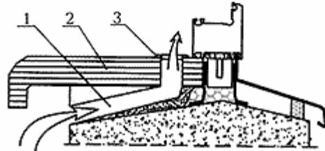
1 – канал подачи теплого воздуха от нагревательного прибора к оконному блоку (штроба в стяжке из штукатурного раствора); 2 – подоконная доска; 3 – декоративная решетка выходного отверстия
