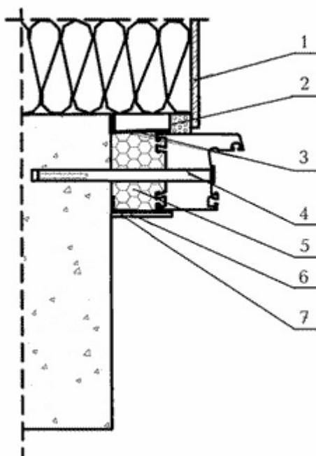
1 – элемент отделки наружного оконного откоса; 2 – изоляционная саморасширяющаяся паропроницаемая лента; 3 – водоизоляционная паропроницаемая лента; 4 – рамный дюбель; 5 – пенный утеплитель; 6 – пароизоляционная лента; 7 – декоративный нашельник
