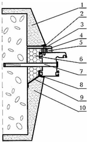
1 – штукатурный слой наружного откоса (с фаской для слоя герметика); 2 – герметик; 3 – нашельник; 4 – дистанционная прокладка (шайба); 5 – изоляционная саморасширяющаяся паропроницаемая лента; 6 – пенный утеплитель; 7 – рамный дюбель; 8 – герметик; 9 – пароизоляционная лента; 10 – штукатурный слой внутреннего откоса (с фаской для слоя герметика)
