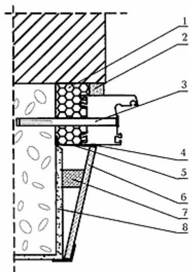
1 – пенный утеплитель; 2 – изоляционная саморасширяющаяся паропроницаемая лента; 3 – рамный дюбель; 4 – герметик; 5 – пароизоляционная лента; 6 – панель отделки внутреннего откоса; 7 – рейка; 8 – штукатурный выравнивающий слой внутреннего откоса
